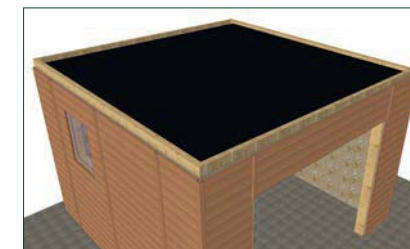
Fig.19 : Replis des rebords de la membrane pour application de la colle
