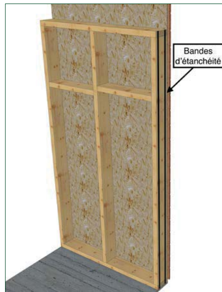
Fig.4 : Emplacement des bandes adhésives
